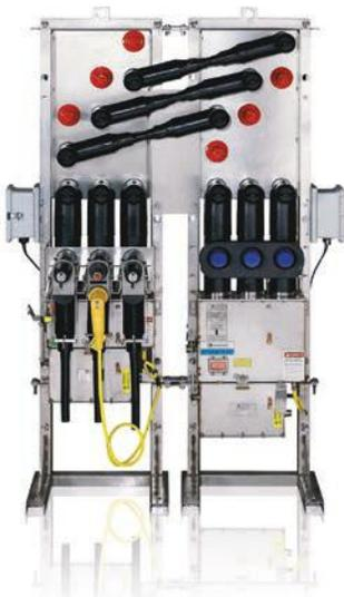
Las unidades sumergibles multivías se fabrican utilizando módulos MVS y MVI de hasta 38 kV, según lo requiera la aplicación. Estos se montan en un sistema moldeado de barras de distribución común y se ensamblan en un marco de montaje independiente, empotrado o de piso.
