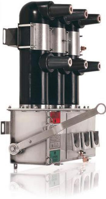
Dispositivos para maniobra de carga y operados por resorte que conducen e interrumpen corrientes de carga a 600 A en sistemas de distribución de 5 a 38 kV.
